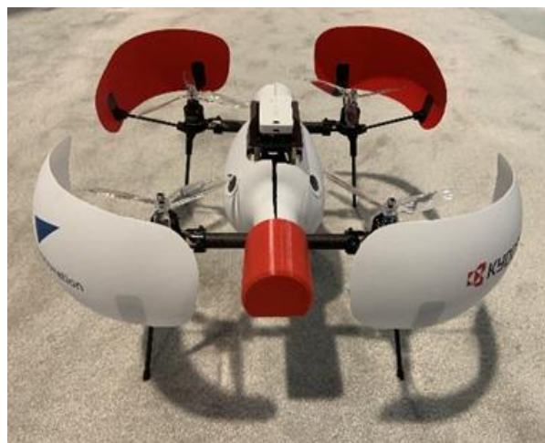
Drones prototypes équipés de stations-relais mobiles de communication
