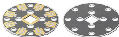
Substrat à liaison filaire pour puce QPU
